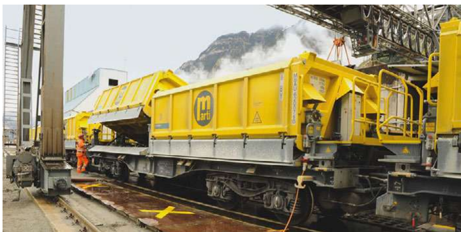
6: Die auf Doppeltragwagen aufgesetzten 20" Module lassen sich elektrisch entleeren
